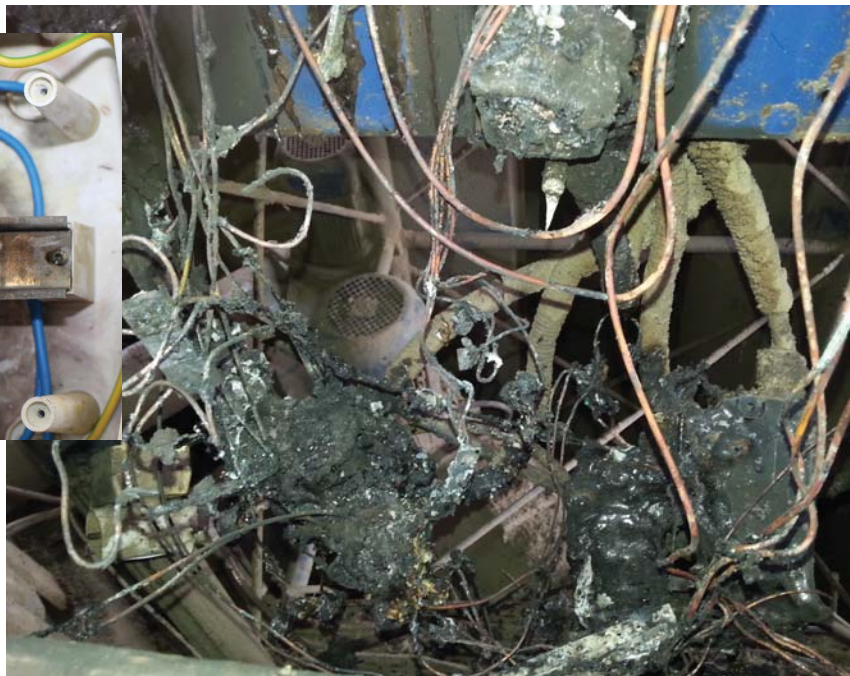
Rys. 8 Pożar spowodowany eksplozją ogranicznika przepięć
