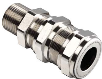
Dławnice Ex do kabli z pancierzem, wykonane z mosiądzu, z podwójnym dławieniem do stref 1,2 i 21, 22
